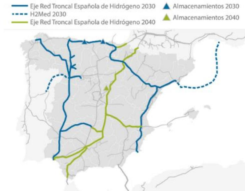
Figura 45. Propuesta de infraestructura básica de hidrógeno propuesta por Enagás para España en 2030 y 2040. Fuente: Enagás
