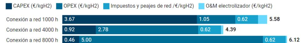
Figura 15. Coste de producción de hidrógeno tomando electricidad de la red para tres escenarios: 1000, 4000 y 8000 horas de funcionamiento tomando tomando precios de la electricidad para el año 2021 <sup>14,15</sup>. Para más información ver notas metodológicas (sección 8.1)
