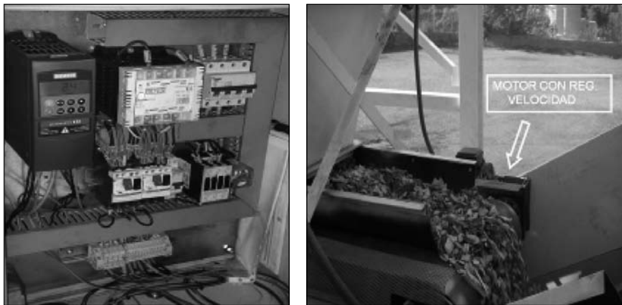
Figura 5: Variador de velocidad y motor para llevar a cabo las pruebas en CT. Velilla. (Fuente: Elaboración propia).
