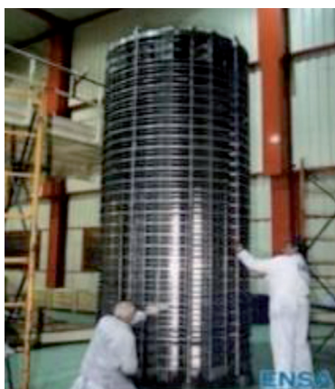
Figura 3: Contenedores en seco para almacenamiento temporal del combustible usado.
