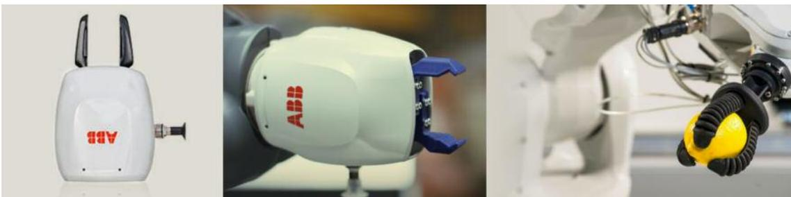
Ilustración 1- Tipos de gripper existentes para el robot YuMi.
