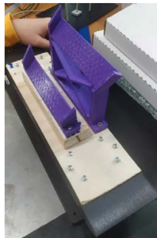
Figura 9. Soporte atornillado en la mesa vibratoria
