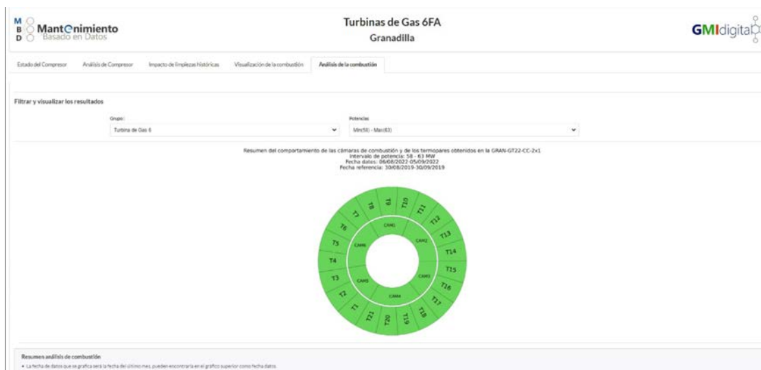
Figura 30. Imagen pantalla de monitorización de la cámara de combustión y de los termopares asociados
