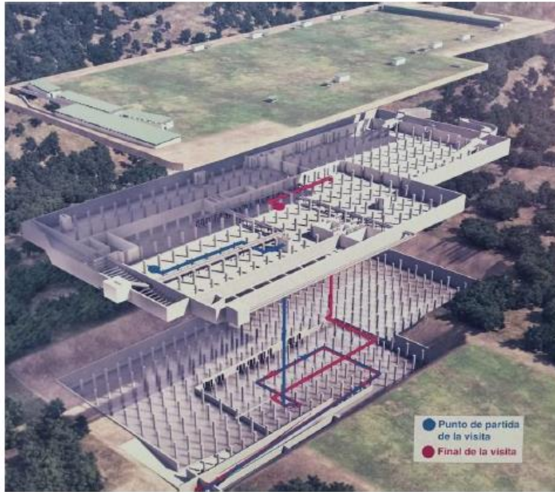
Fig. 11. Esquema conceptual del tanque de tormentas en la campa de vehículos.
