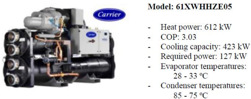
Fig. 5. Bomba de calor industrial para revalorizar el agua de refrigeración de los compresores.
