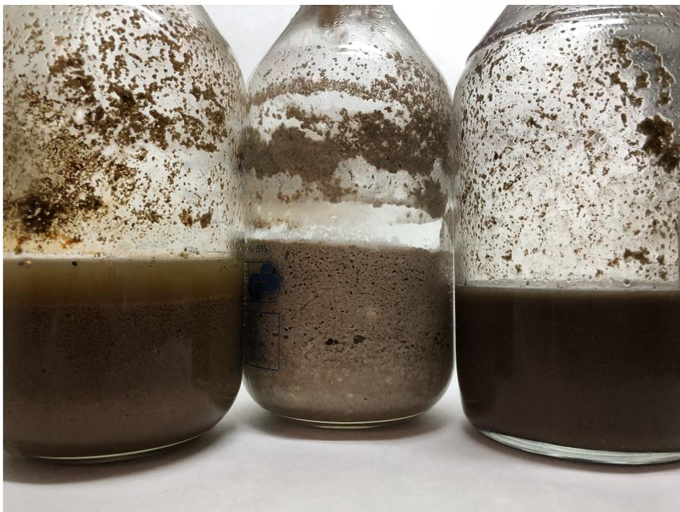
**Figura 5.36:** Aspecto externo del digestato tras la finalización de los ensayos BMP de los residuos V, C y P (de izquierda a derecha)
