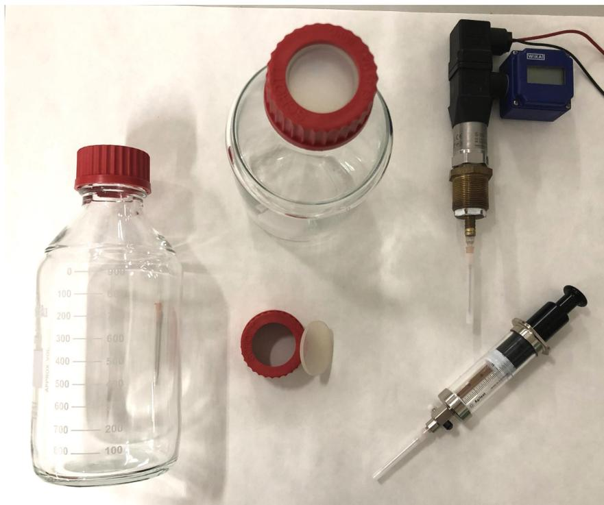
**Figura 4.7:** Material empleado para los test BMP
