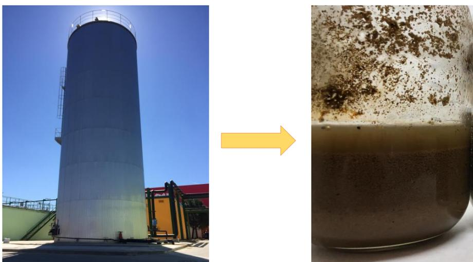
**Figura 4.1:** Detalle del reactor UASB del que se extrae el fango y del propio fango granular.
