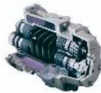
Figura 2.3.4. Motor de tornillo. (Fuente: OGES)
