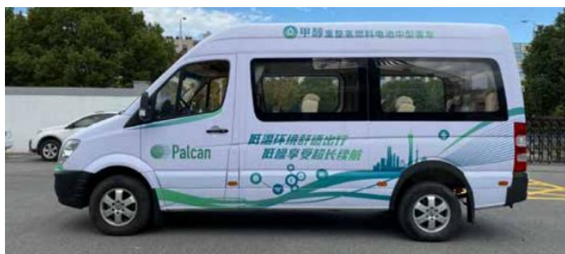
Figura 4: Autobús de pasajeros en China con reformador híbrido de metanol y célula de combustible de membrana de intercambio protónico (PEMFC) de Palcan [8]
